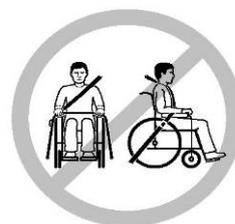
Korrekte Position des Sicherheitsgurts      Falsche Position des Sicherheitsgurts
