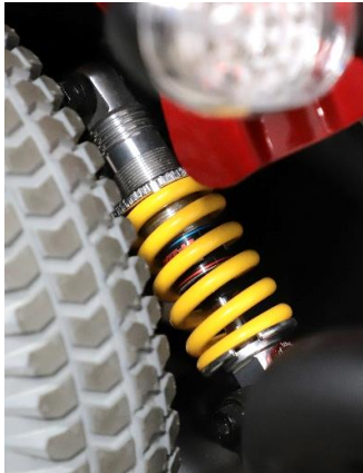
Federeinstellung zwischen linker und rechter Seite messen
