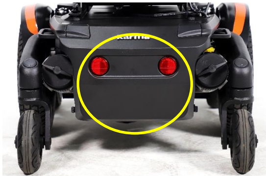
Position der hinteren wartungsfreien Batterien
