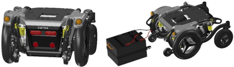
Position der wartungsfreien Batterien
