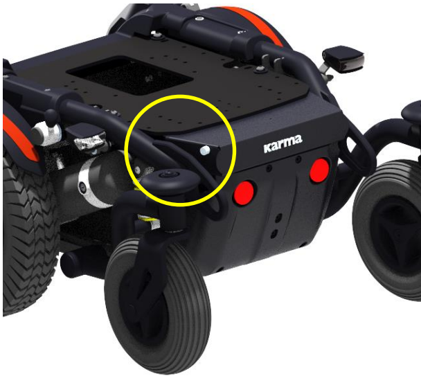
Position der Hauptsicherung
