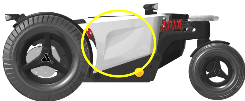
Compartiment des batteries
