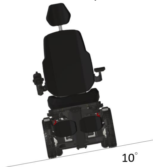
Conduite en dévers
