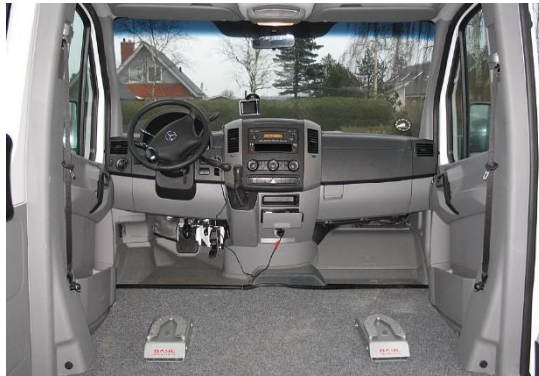
Station d'arrimage Dahl montée sur le sol
