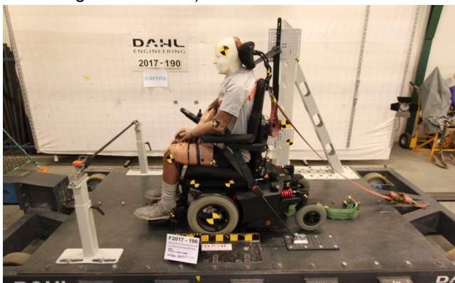
Crash test du fauteuil EvO Lectus à l'aide de la station d'arrimage Dahl.
