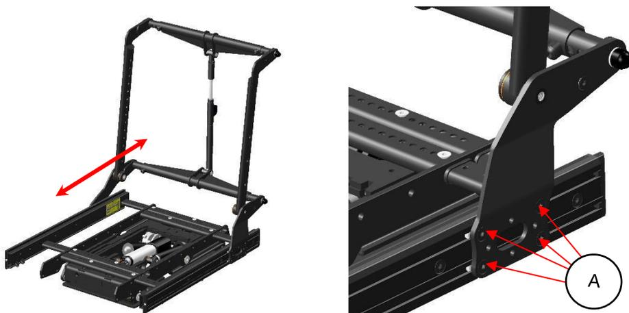
Étape 1 : Desserrez les 4 boulons de chaque côté du support de dossier (A) à l'aide d'une clé Allen de 4 mm.
