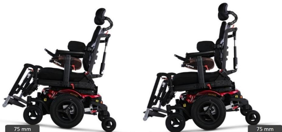
Lorsque vous conduisez sur une surface plus élevée (comme un trottoir), soyez toujours conscient du mouvement brusque vers l'avant de votre fauteuil roulant lorsque vous le descendez. Si votre fauteuil roulant est équipé d'un système d'inclinaison électrique du siège, vous pouvez utiliser l'inclinaison du siège pour plus de stabilité lors de la conduite sur la chaussée.
