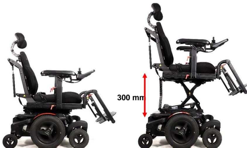
Pendant l'utilisation du lift, la vitesse de conduite sera toujours automatiquement réduite pour des raisons de sécurité. En position assise haute, l'inclinaison du siège sera également bloquée pour obtenir une stabilité maximale. La hauteur du siège peut être réglée sur chaque position de hauteur par l'utilisateur.
