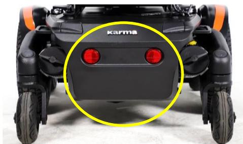
*Position des batteries arrière*
