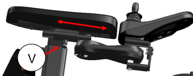
Étape 1 : Desserrez les boulons (V) à l'aide d'une clé Allen de 5 mm.
