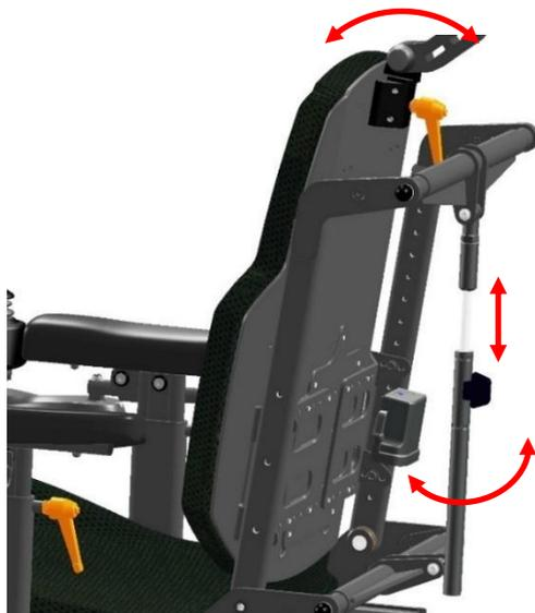
Le dossier inclinable à réglage mécanique utilise un tube télescopique en continu avec levier de dégagement rapide et de verrouillage. Le réglage d'inclinaison mécanique a le même réglage d'angle dynamique que le système d'inclinaison électrique.
