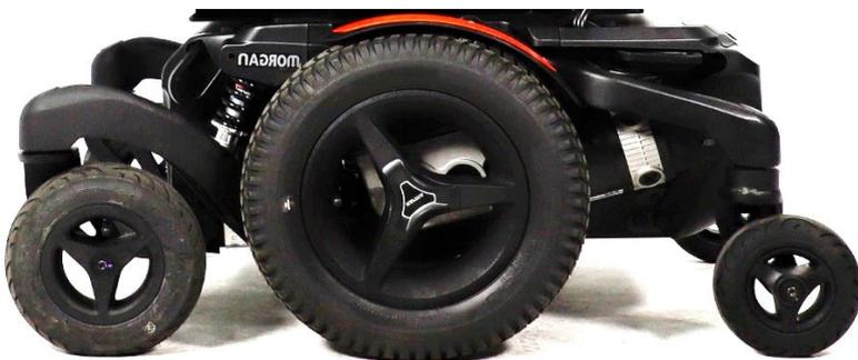
Chacune des roues centrales est propulsée par un puissant moteur d'entraînement. Ces moteurs s'occupent également de la direction du fauteuil roulant. Avec ce système il est possible de tourner sur place. Cela rend le fauteuil roulant optimal pour une utilisation en intérieur.
