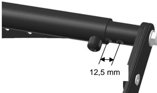
Étape 5 : Fixez la bonne position en montant à nouveau les boulons en forme de dôme dans les trous désignés, puis serrez les boulons d'extrémité pour fixer ce côté du siège.
