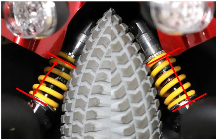
*Mesure du réglage du ressort entre les côtés gauche et droit*
