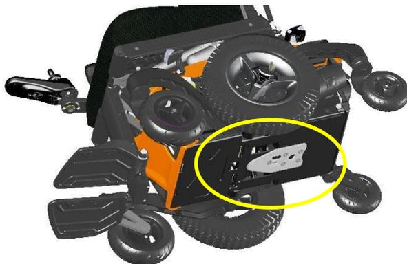
*Châssis Morgan M avec plaque d'amarrage Dahl montée.*
