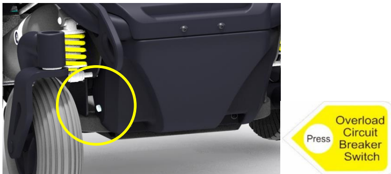
Position du disjoncteur
