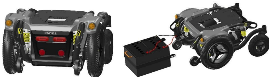
Position des batteries
