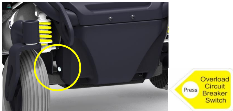
Position du disjoncteur
