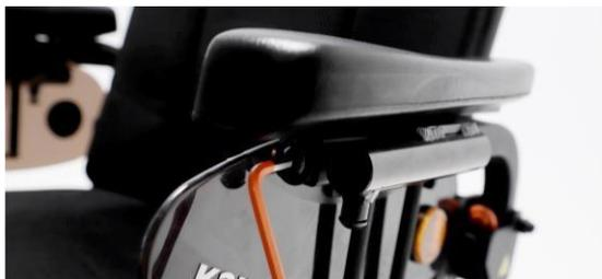
Étape 1 : Utilisez une clé Allen de 5 mm du kit d'outils KARMA pour desserrer les boulons de réglage de la hauteur sous le coussin d'accoudoir.
