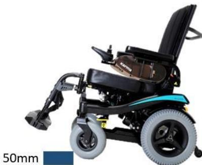
Lorsque vous conduisez sur une surface plus élevée (comme un trottoir), soyez toujours conscient du mouvement brusque vers l'avant de votre fauteuil roulant lorsque vous le descendez. Si votre fauteuil roulant est équipé d'un système d'inclinaison électrique du siège, vous pouvez utiliser l'inclinaison du siège pour plus de stabilité lors de la conduite sur la chaussée.
