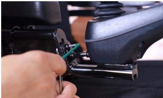
Étape 1 : Utilisez une clé Allen de 3 mm et une clé ouverte de 8 mm pour desserrer ce boulon.
