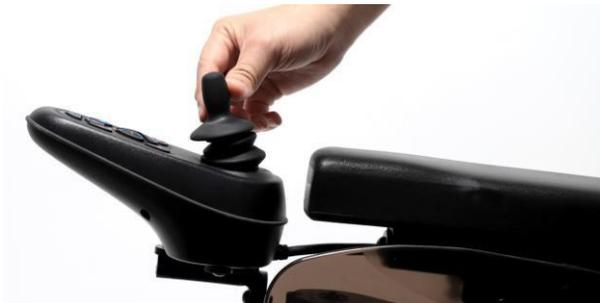
Étape 2. Poussez le joystick vers l'avant jusqu'à ce que le système de commande émette un bip.
