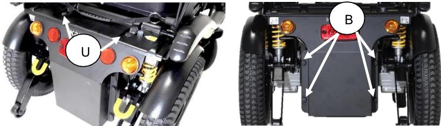
Après avoir retiré le couvercle, la batterie peut être retirée de la boîte. Attention aux câbles ! Lors de l'installation de la batterie, il faut faire très attention à ce que les câbles ne soient pas coincés entre la batterie et le boîtier de la batterie.
