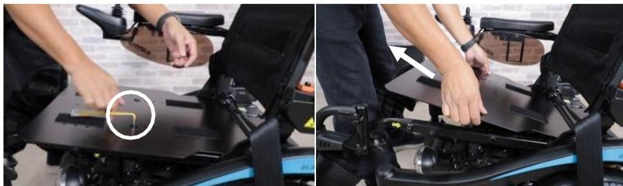
Étape 4. Utilisez la clé Allen de 4 mm pour dévisser le boulon pour enlever la plaque de siège. Lorsque vous retirez la plaque de siège, inclinez-la d'abord vers le haut, puis tirez.
