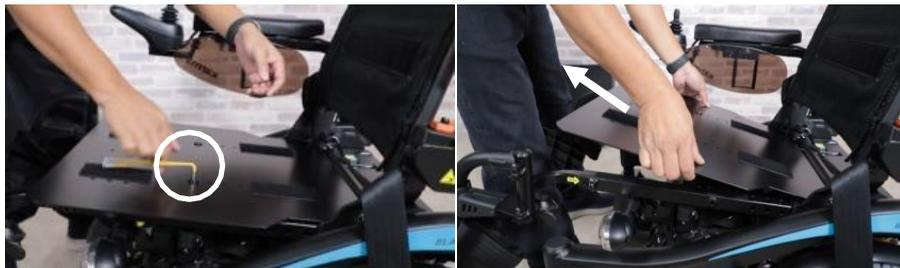
Étape 2. Utilisez la clé Allen de 4 mm pour dévisser le boulon reliant la plaque de siège. Lorsque vous retirez la plaque de siège, inclinez-la d'abord vers le haut, puis tirez.
