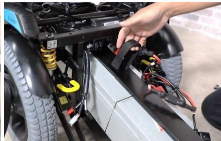
Étape 9. Utilisez la sangle arrière et avant pour retirer la plaque de la batterie
