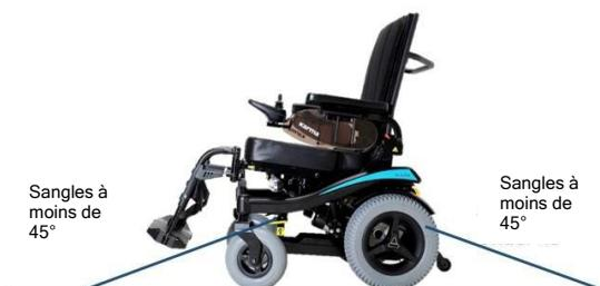
L'angle des sangles doit être d'environ 45° par rapport au plan horizontal. Ceci doit avoir un effet maximum dans la direction verticale et horizontale.
