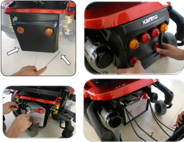
positie en bereikbaarheid van de onderhoudsvrije accu's
