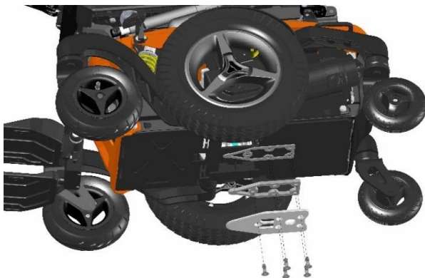
Montage van de Dahl docking plate op het chassis van de Morgan M Versus (MGNM-VRS).
