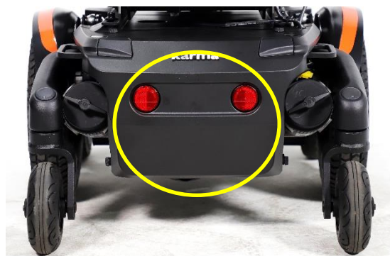
Positie van de achterste onderhoudsvrije accu's
